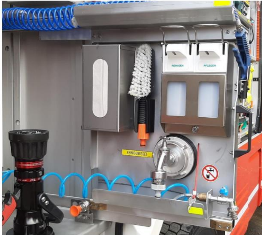
Hygieneboard an einem Fahrzeug mit Wasserversorgung
